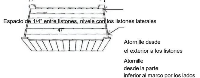
5 **PARTE SUPERIOR:** atornille los 1 x 2 en la parte inferior de los listones superiores usando 1 1/4" y pegamento. Fije la parte superior al banco con bisagras.
